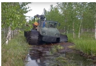
Рис. 4. Возможность работы «Тром-20» при трелёвке древесины в труднодоступных почвенно-грунтовых условиях на грунтах III и IV категории
