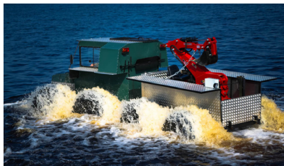
Рис. 6. Мобильный плавающий экскаватор на базе вездехода «Тром-8»
